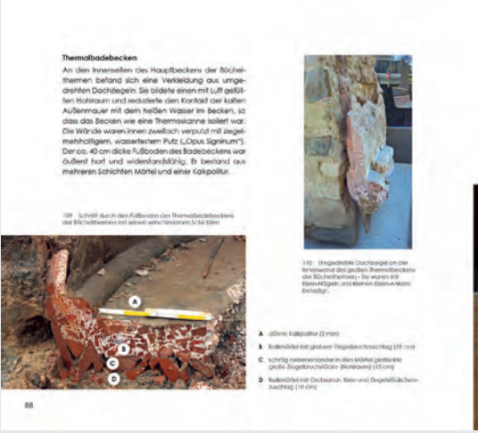
121. Im Inneren des Badebeckens am Fußboden des Thermalbades bei Aachen. Die Mauerwerksteile sind aus Ziegeln, die Fußboden aus Stein.
